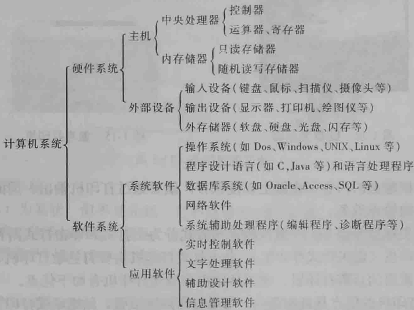
图 1-18 计算机系统结构
