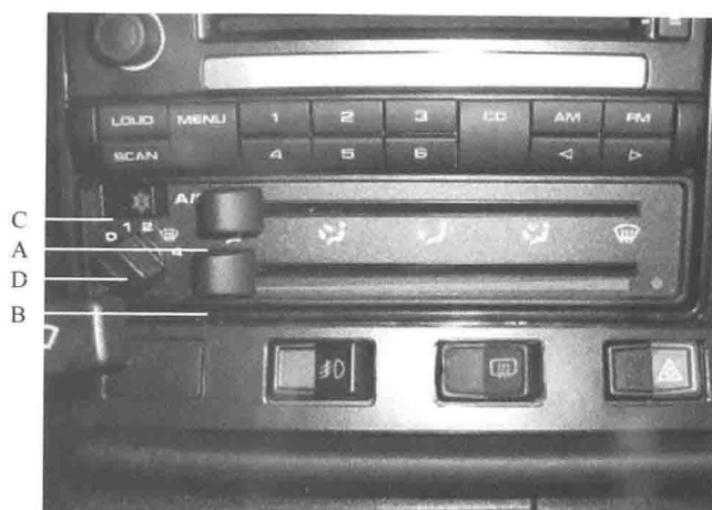
图 1-1 桑塔纳空调系统控制面板
