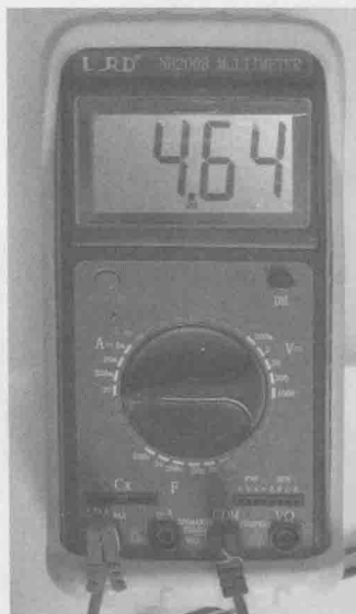
图 1-9 电源适配器输出的直流电压
