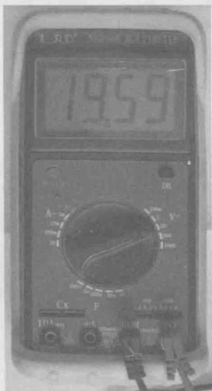
图 1-8 表头直接显示测量出的电压值
