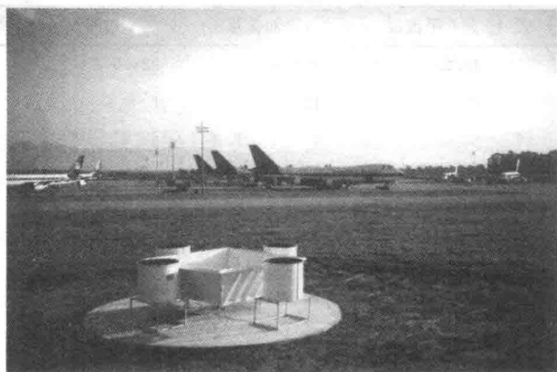
图 1.1 LAP-3000 边界层风廓线雷达
