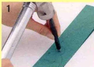
在打孔时，使用打孔机会非常方便，它有很多口径。使用时将纸放在坚硬地面上用锤子敲打完成。
