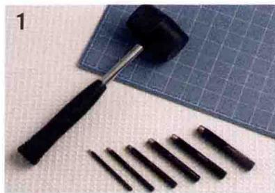
打孔机有很多口径，最好多准备几个不同口径的。
