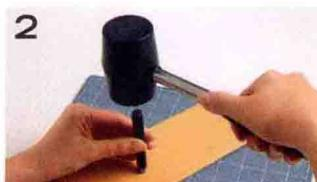
在混凝土或地板之类的硬面上放置剪裁垫后轻叩打孔。
