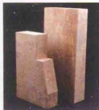
VEGA硅砖由美国Harbison-Walker公司授权TNCR生产，采用VEGA技术工艺，液压机成型，梭式窑烧成，生产出的玻璃窑用优质硅砖具有“一小一高两低”的特点，即尺寸公差小，熔融指数低，残余石英低，荷软温度高。
