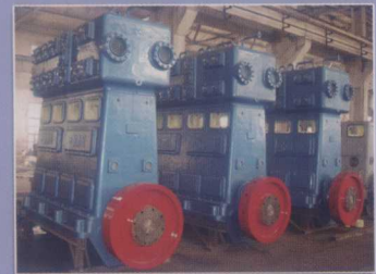
氧、氮压缩机 气量800~6500m 3 /h
