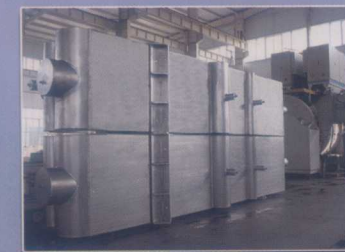
铝制板翅式换热器
