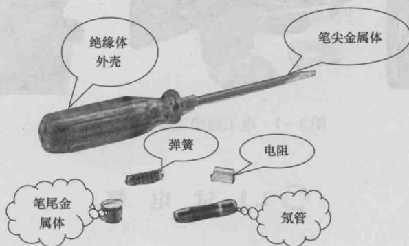
图 1-3 试电笔的基本结构
