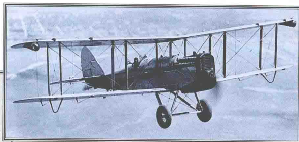
▲ DH.4B型航空邮件机先驱 剩余的DH.4型飞机转给美国邮政部，以建立航空邮件服务。前方的驾驶员座舱用于装邮件袋。这种飞机有两个翼尖着陆灯。
