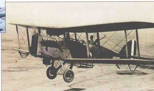
上图：战后，DH.9A型飞机经过了“热带化”处理，以在伊拉克与西北边境使用。这种飞机在机头下方配有1个额外的散热器，在右舷上机翼下方配有1个超载的油箱。
