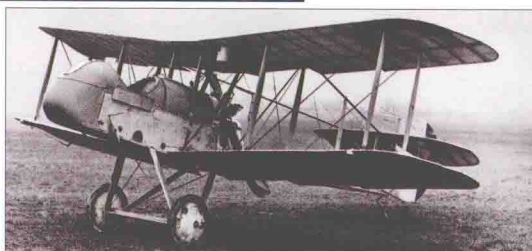
下图: 飞行员完全受到DH.2型飞机各组件的影响,但是其视野却是无与伦比的。飞行员不久便开始将机枪用作固定武器,且使整个飞机实施机动,以对目标进行瞄准。
