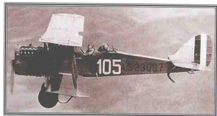
▲ DH.4B型航空邮件机先驱 剩余的DH.4型飞机转给美国邮政部，以建立航空邮件服务。前方的驾驶员座舱用于装邮件袋。这种飞机有两个翼尖着陆灯。
