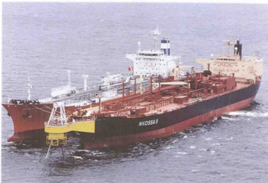
(b)NKOSSA II——浮式液化石油气储存装置(LPG FSO)。载重量为 5.03 万吨。西非刚果 NKOSSA 油田,水深 135 米。
