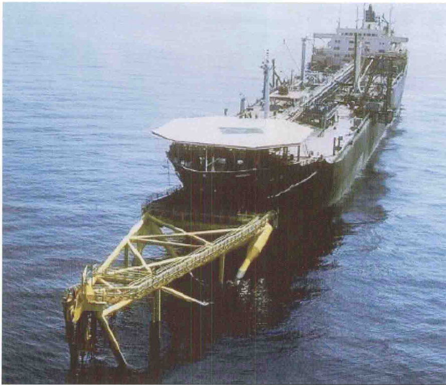
(d)世界上第一艘 FSO,由载重量为 5.9 万吨旧油船改装。设计:SBM 公司。改装:西班牙船厂。船级:BV。业主:壳牌石油公司,1977 年用于地中海卡斯特利翁油田作业。系泊系统是 Single Anchor Leg Storage,简称 SALS。
