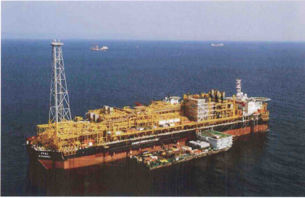
(e)世界上最大的“GIRASSOL”FPSO,载重量为34.3万吨。SBM设计,韩国HHI船厂建造,入BV级。业主道达尔石油公司,2001年用于安哥拉Jasmin17区块油田作业。
