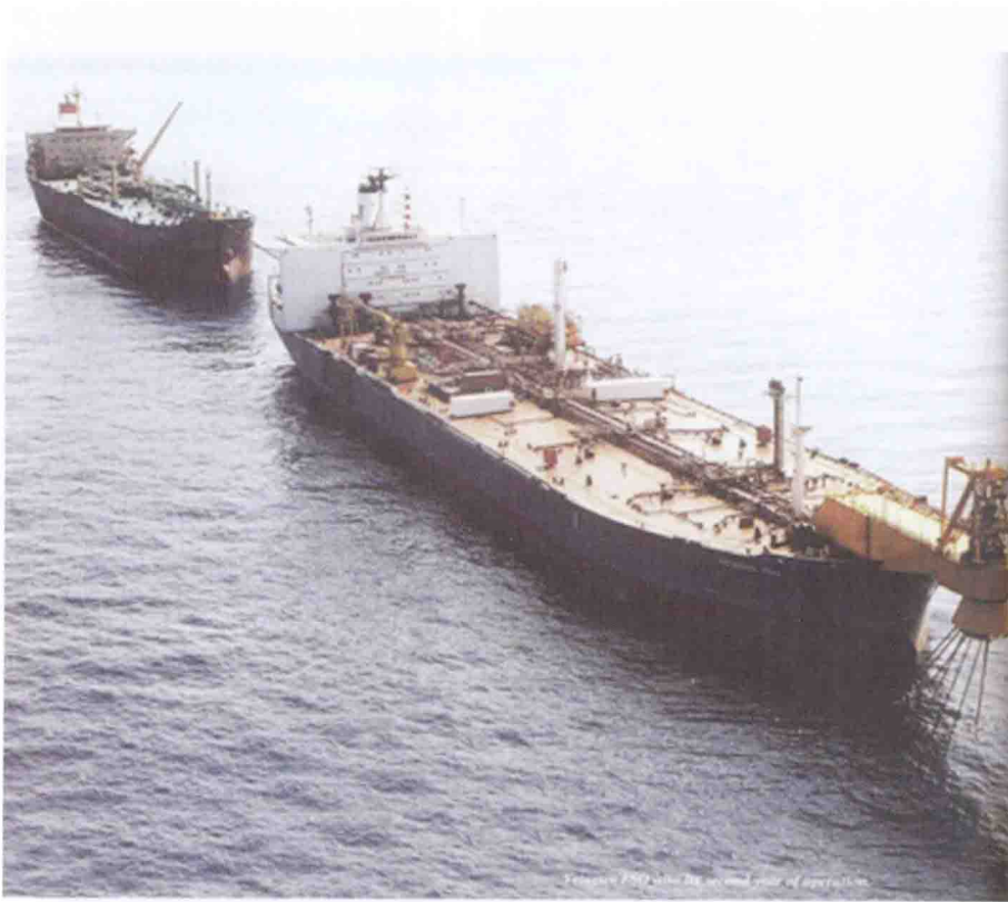
(a)NKOSSA I——浮式储卸装置(FSO)。载重量为 27 万吨。西非刚果 NKOSSA 油田,水深 126 米。
