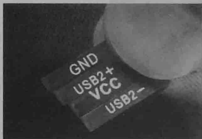
图 1-15 机箱面板前置 USB 的连接线
