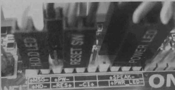
图 1-14 主板上的硬盘运行指示灯、重启键、PC 喇叭及电源的连接插脚
