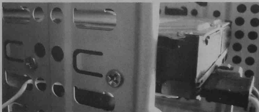
图 1-11 在硬盘驱动器舱中用螺丝固定硬盘
