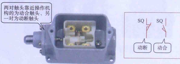
图 1-6 行程开关的外形及图形符号
