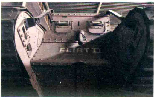
■ Mark IV坦克的前面安装一门火炮，可以看到两侧的观察口
