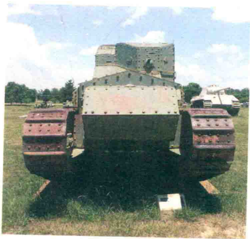
■ “赛犬” A中型坦克的正面照，其后方的固定炮塔很突出
