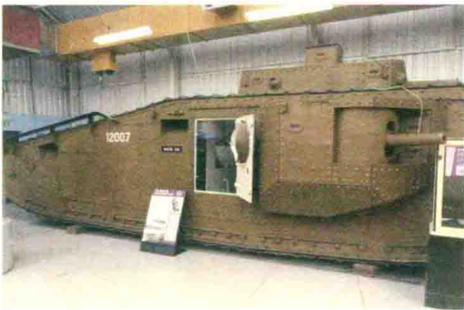
■ 博物馆中的Mark VIII坦克，可以看到顶部的小指挥塔和一侧的火炮
