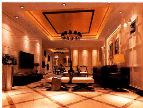
顶面 [ 金箔 + 木线条装饰框刷黑漆 ]
