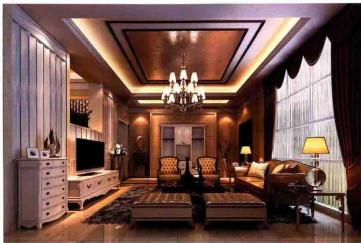
顶面 [ 石膏板造型 + 银箔 + 木线条装饰框刷黑漆 ]
