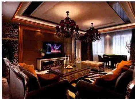
顶面 [ 黑镜 + 木线条喷金漆走边 ]
