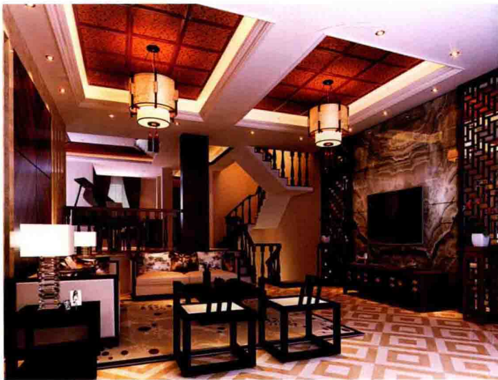
顶面 [ 墙纸 + 木线条打方框 ]
