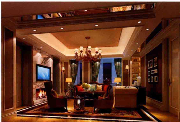
顶面 [ 石膏板造型 + 彩色乳胶漆 + 金属线条装饰框 ]
