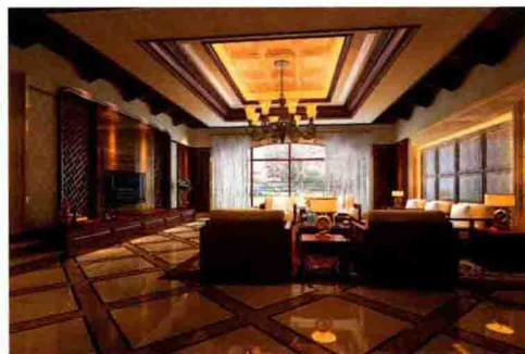
顶面 [ 木线条走边 + 石膏板造型贴金箔 ]
