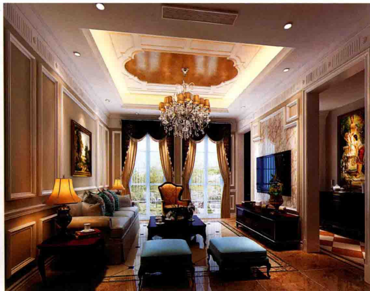
顶面 [ 石膏板造型 + 金箔 + 木线条装饰框刷白 ]
