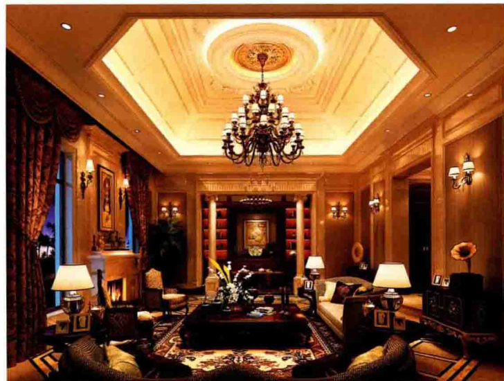
顶面 [ 石膏板造型 + 石膏浮雕喷金漆 ]
