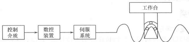
图 0-4 开环数控系统的结构框图
