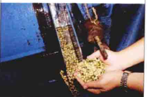
经过果肉去除机处理内果皮上附着黏膜的咖啡豆（哥斯达黎加）
