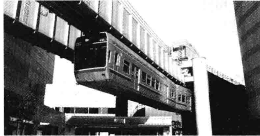
图 1-5 日本千葉市的悬挂式独轨交通
