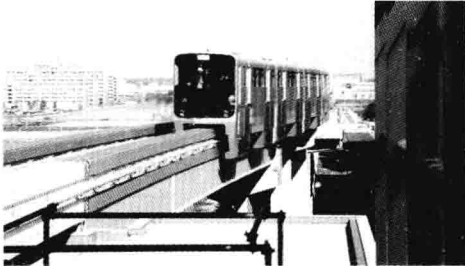
图 1-4 日本多摩市的跨座式独轨车
