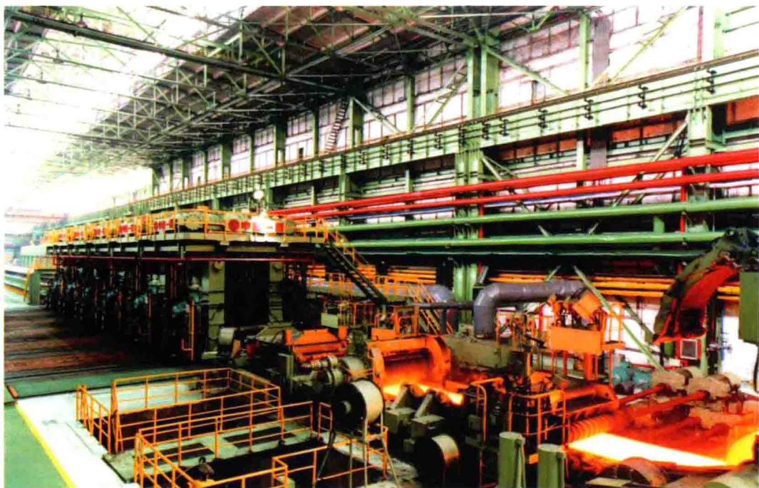
2000年，鞍钢1700中薄板坯连铸连轧生产线（ASP）。
