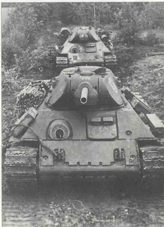
T-34 1941型坦克在炮塔正面和驾驶舱门增加了装甲，对抗越来越多的德国牵引式及自行75毫米反坦克炮的威胁
