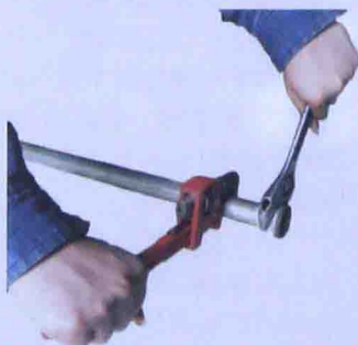
图 1-18 管子钳的使用方法
