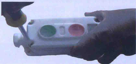
图 1-4 螺钉旋具的使用方法
