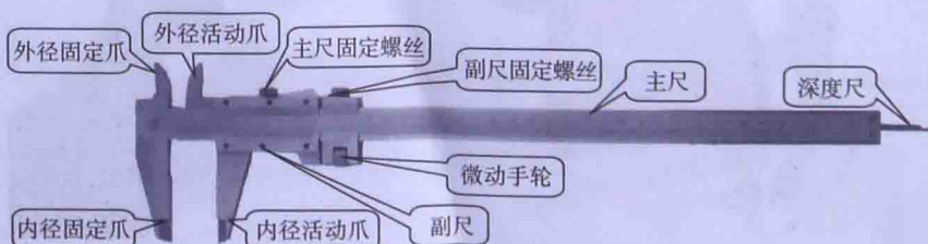
图 1-21 游标卡尺外形
