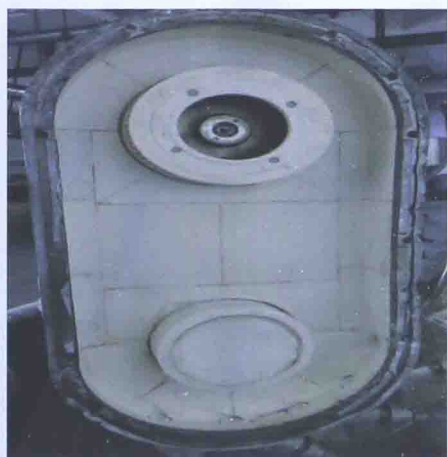
(d) O型循环式气磨的陶瓷腔体
