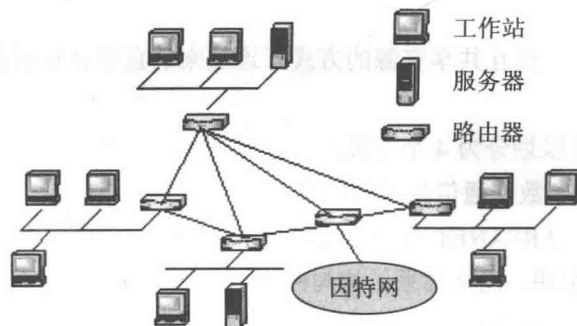
图 1-2 校园网、企业网与 ISP 的网络结构示意图
