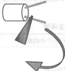
图 1-1-12 瓷片电容器 引线成型示意图
