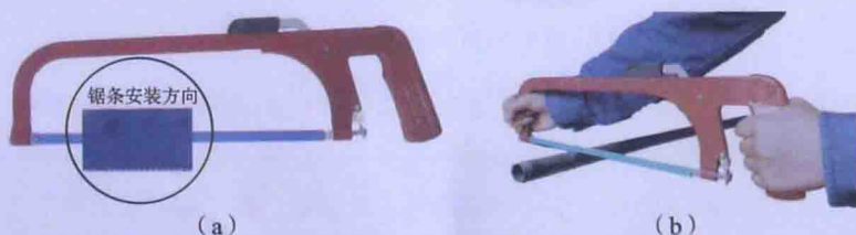
图 1-13 手锯外形及使用方法 (a) 外形；(b) 使用方法
