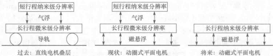
图 1.6 Lomonova 和 Duarte 提出的光刻机平面电机技术研究方向
