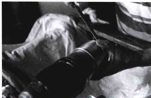
抛光。用车轴粘住套筒，抛光时把圆型锡器套在套筒上，用脚踩动绕在车轴上的绳索，带动锡器旋转。用皂荚树果实煮泡的液体做清洁剂，用锉刀、刮刀和沙朴树叶来抛光。
