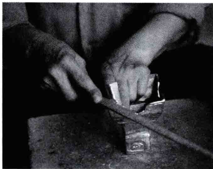
锉。用专用的锉刀把焊接部位锉平，对锡器的造型进一步修整。锉细微处时，锉刀极易伤到手指，范师傅在食指上套了一只铁制的护指套，这是老一辈传下来的劳保措施。
