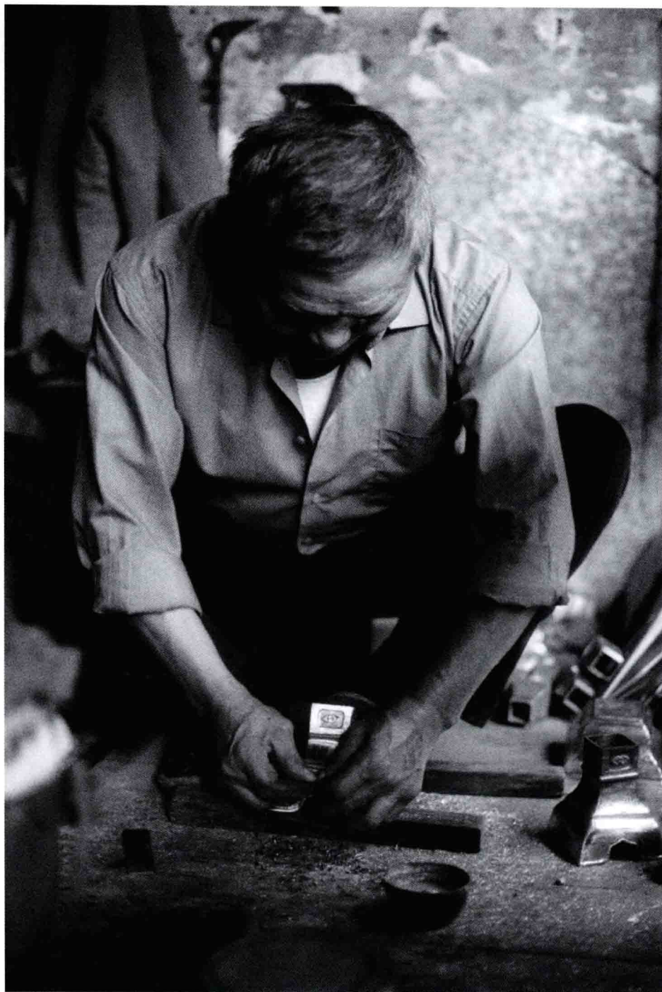
锉。用专用的锉刀把焊接部位锉平，对锡器的造型进一步修整。锉细微处时，锉刀极易伤到手指，范师傅在食指上套了一只铁制的护指套，这是老一辈传下来的劳保措施。
