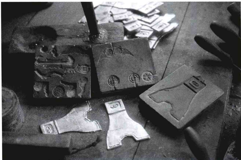
用太湖石雕成的各种模板。锡器的各种图案，如狮子、龙凤等装饰件，以及壶嘴、壶柄之类的配件，都是用模板浇铸出来的。
