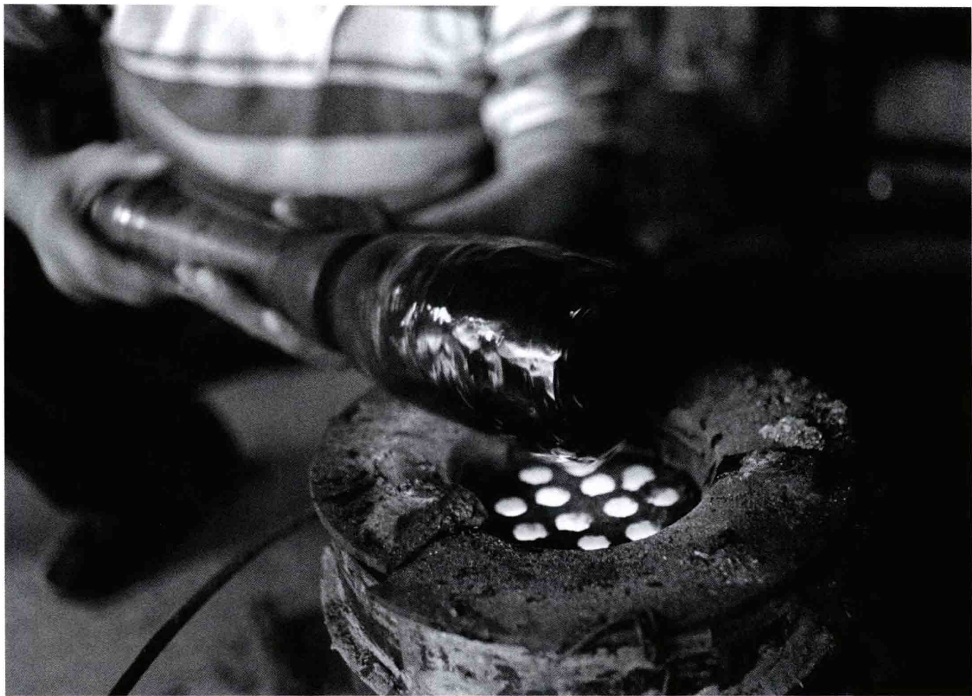
制作车头胶。这是抛光的一个重要工具，用松香、香灰和菜油经煎熬混合而成，把车头胶涂在葫芦型的车轴上，冷却后能产生很强的粘力。
