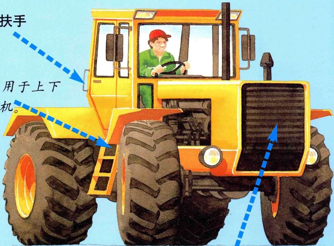
它有4个大小相同的巨大轮胎。为了获得最大的抓地力，它采用四轮驱动：发动机同时驱动4个轮子，而不是2个。
