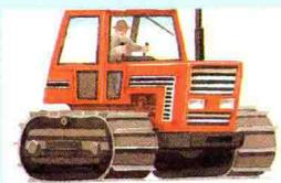
与使用大轮胎的拖拉机相比，履带式拖拉机能够在石头很多的地方或者十分光滑的地面上行驶。
