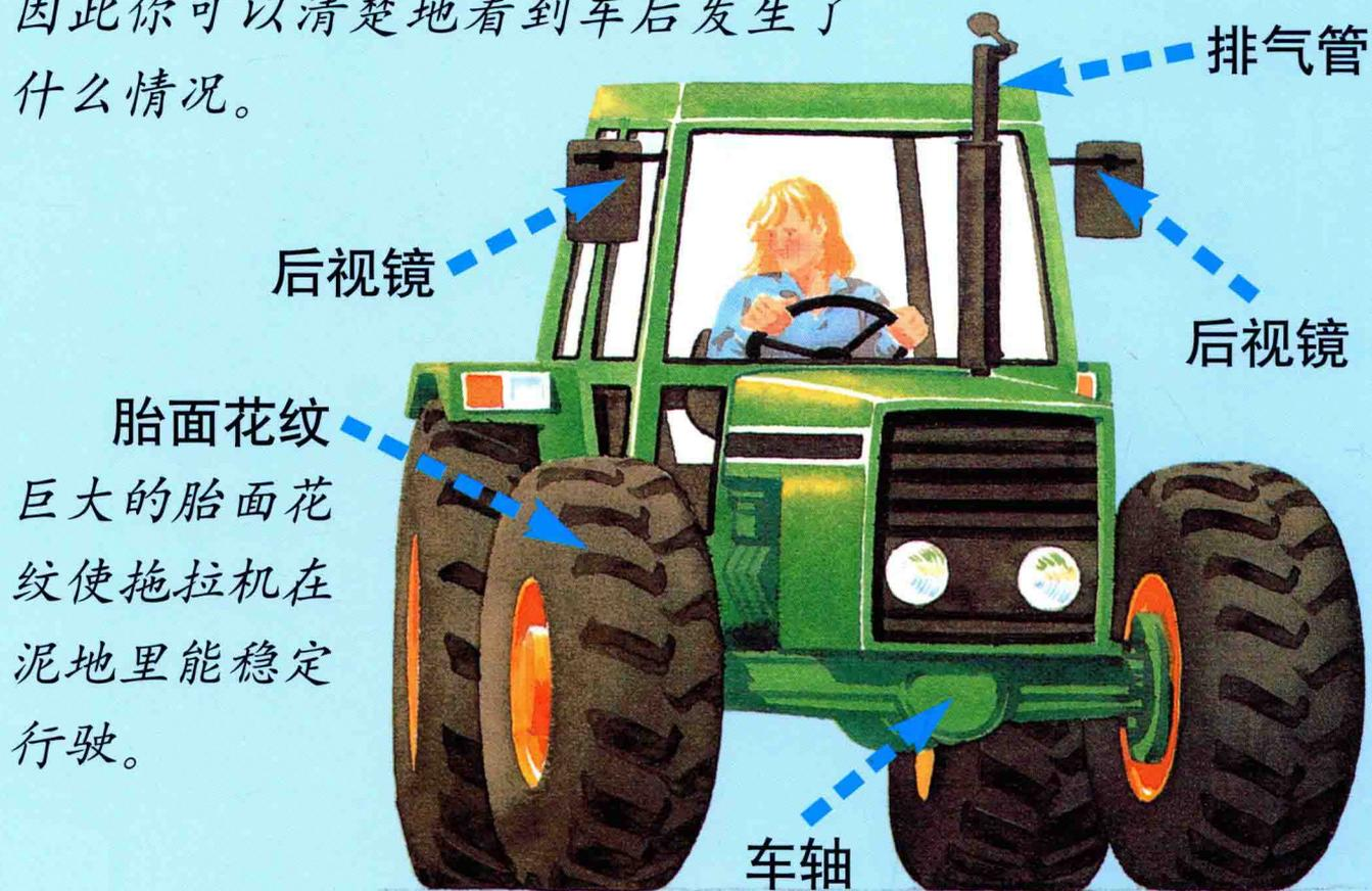
车轴连接车轮与底盘，必须十分结实，因为它经常会在凹凸不平的地面上剧烈颠簸。2个前轮和2个后轮各有一个车轴。
