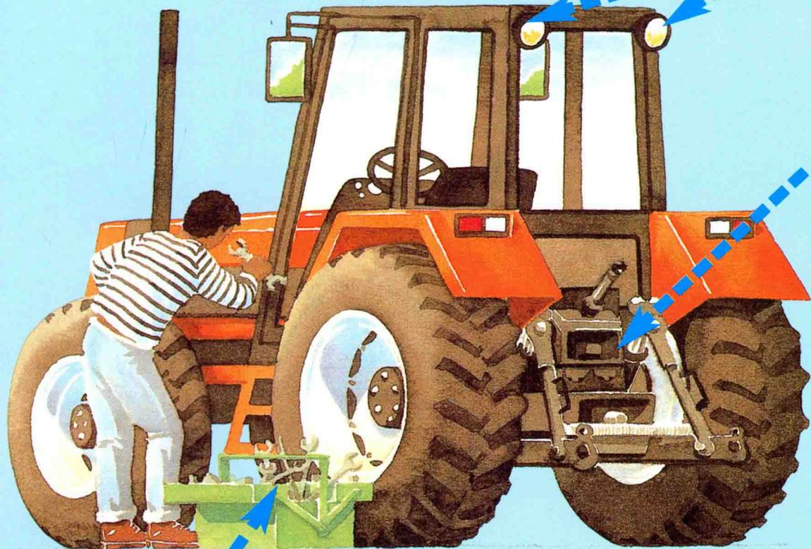
工具箱里面装有各种修拖拉机的工具，包括扳手、钳子、螺丝刀，当然还有锤子。一些检测电路的工具也装在里面。此外，机械师还带着替换部件。
