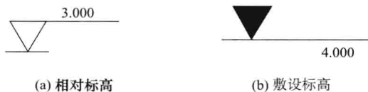
图 1-8 安装标高表示方法
