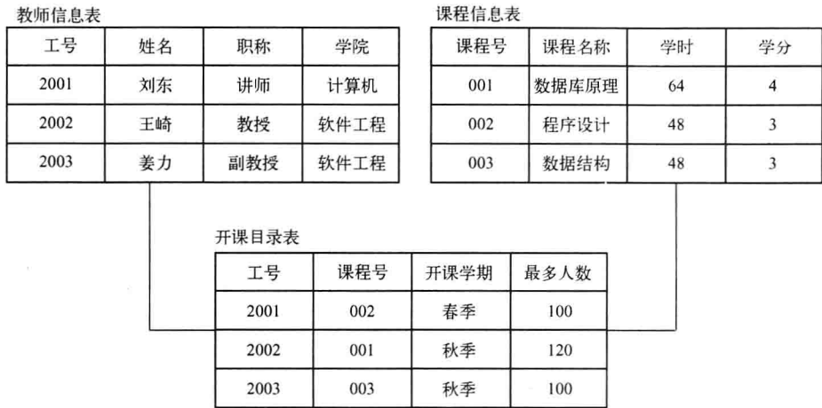
图 1-3 课程目录系统关系数据模型
