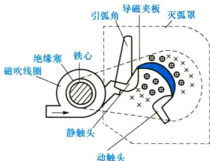
图 1-1-6 磁吹灭弧示意图
