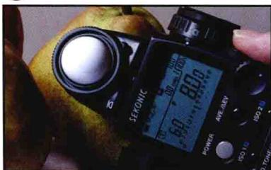
将相机的快门速度输入测光表，将测光球放置在被摄物体前。然后试一次闪光检查其亮度。出现在测光表上的数值为f8。
