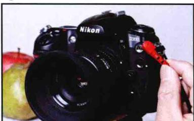
用专用的连接线将相机和闪光灯连接起来。快门信号会通过这根线传达到外置闪光灯。
