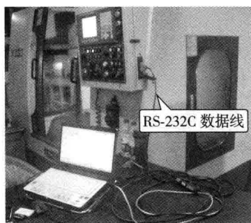
图 1.6 采用 RS-232C 数据线实现 PC 与 CNC 之间的数据传输
