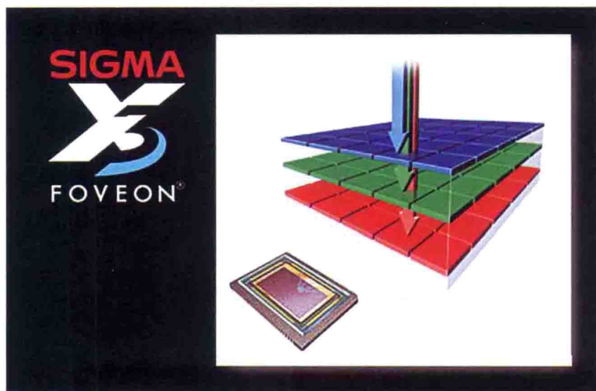
▲ 彩图 2 Foveon X3 传感器的标志符号和它的三层感光技术示意图
