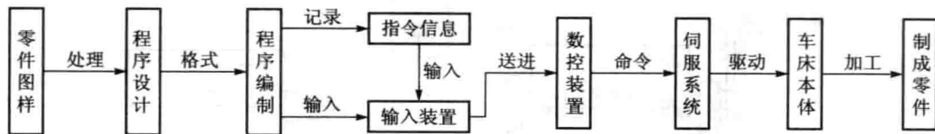
图1-5 数控车床的工作过程
