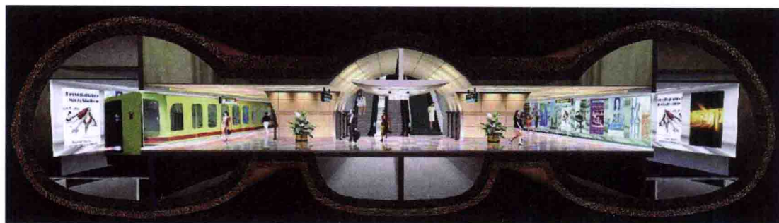
(b) 暗挖地铁车站结构
