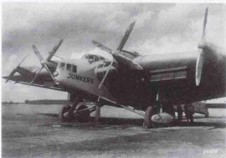
▲ 1930年的时代奇观之一容克斯G 38（注意一个有趣的细节，G 38的全部4台引擎中，只有最内侧的两台配用了4叶木制可变距螺旋桨，最外侧的两台配用的则是2叶螺旋桨）。
