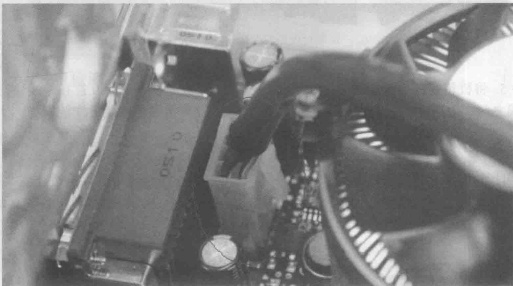
图 1-19 电源与CPU供电接口连接
