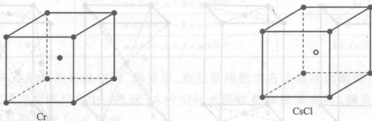
图 1-13 晶体结构相似而点阵不同
