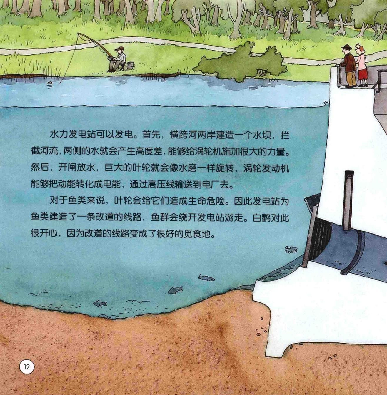
水力发电站可以发电。首先，横跨河两岸建造一个水坝，拦截河流，两侧的水就会产生高度差，能够给涡轮机施加很大的力量。然后，开闸放水，巨大的叶轮就会像水磨一样旋转，涡轮发动机能够把动能转化成电能，通过高压线输送到电厂去。
