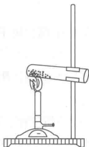
图 1-2 加热试管中固体
