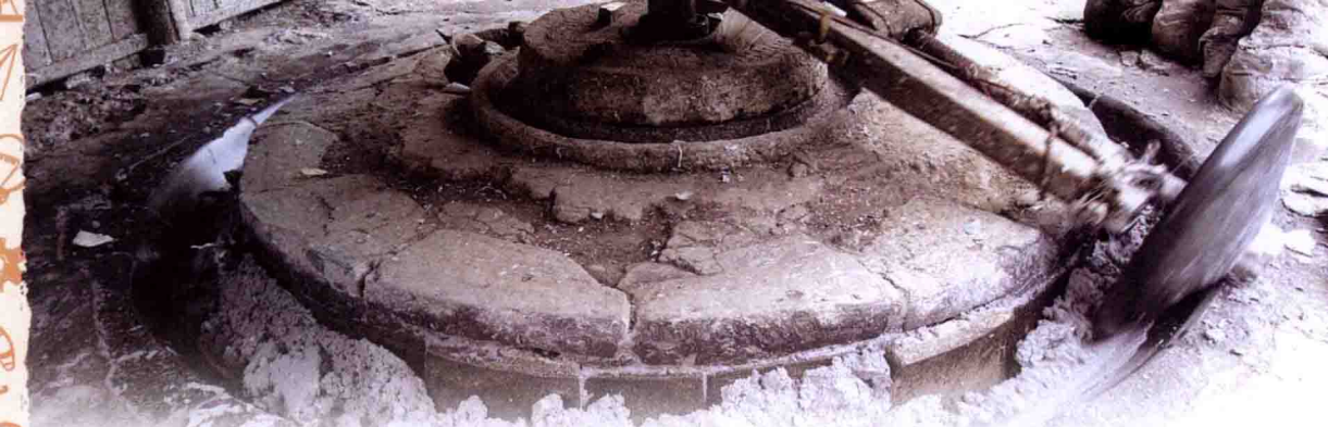
碾纸浆工序，贵州印江县合水镇木腊村 (蔡伦古法造纸村)水碾房。
