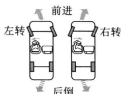
图1-3 转向盘的转动方向与汽车驾驶方向关系
