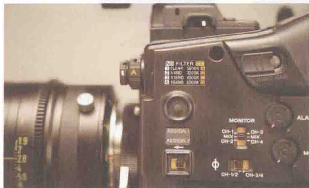
图 1-1-4 数字摄像机面板上 CCD 成像面的位置指示
