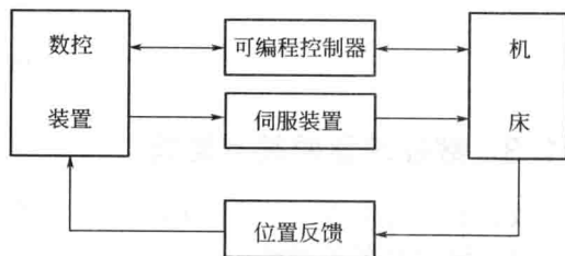
图 1-1 数控机床的基本构成
