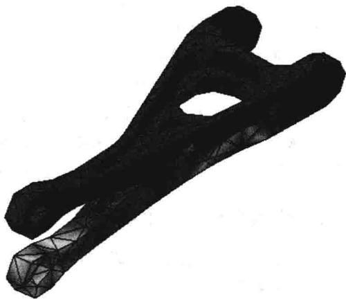
图 1-4 未变形的网格和变形形状上绘制的冯·米塞斯应力图
