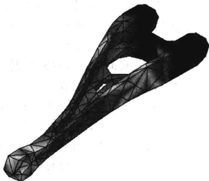
图 1-5 冯·米塞斯应力绘制在变形形状上，未网格从视图中删除
