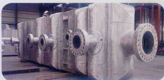
出口美国 9.0MPa 高压换热器
