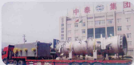
乙烯装置冷箱及塔顶冷凝器发运
