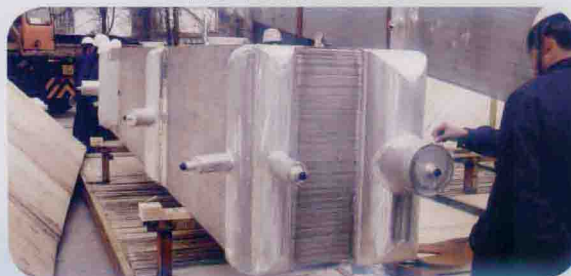
替换中石油兰化原进口高压主换热器
