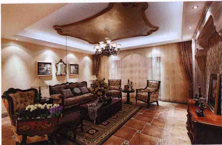
实木线条喷金漆收口
