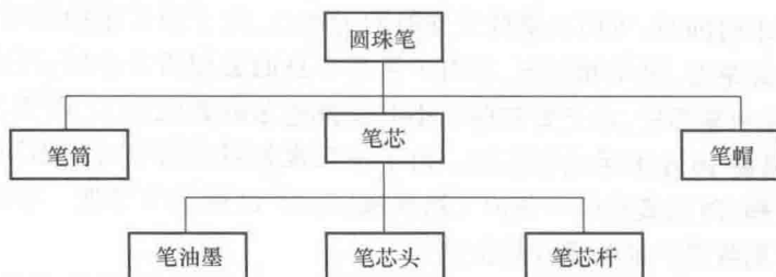
图 1.1.2 圆珠笔的产品结构
