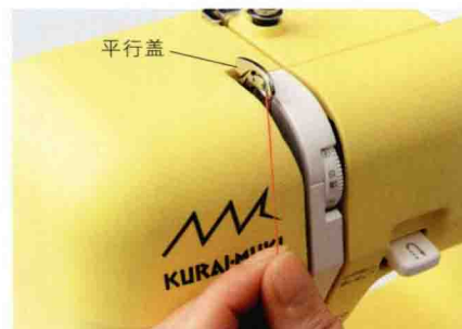
3. 抬起压布脚，转动手轮，把线绕到平行盖最上方。
