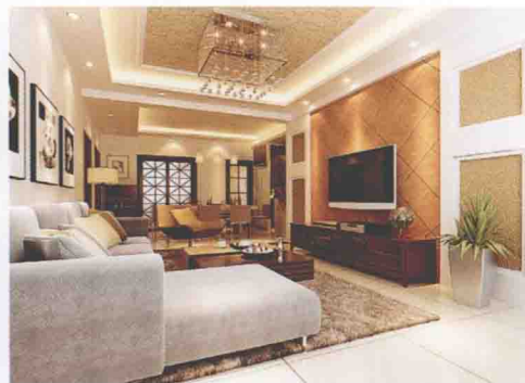
电视墙 [ 米黄大理石斜铺 + 墙纸 ]
