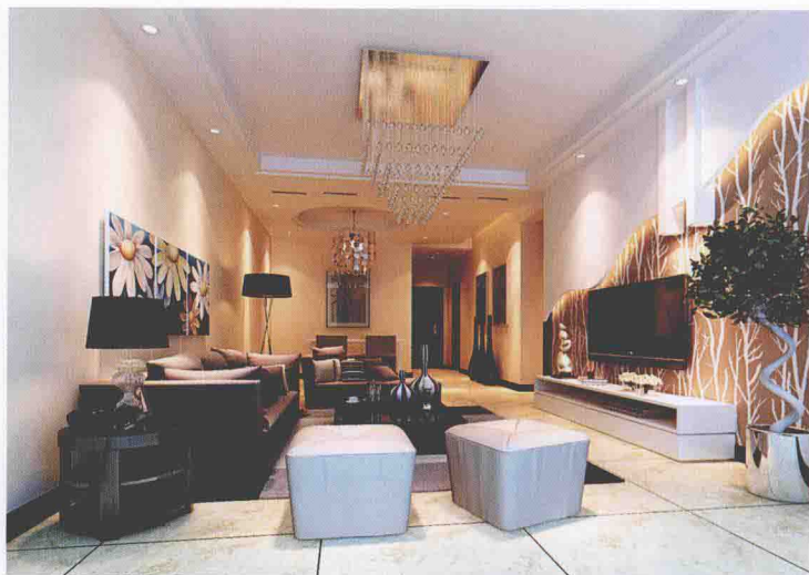
电视墙 [石膏板造型 + 墙纸]
