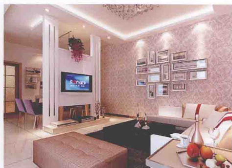
电视墙 [ 石膏板造型 + 不锈钢线条 ]
